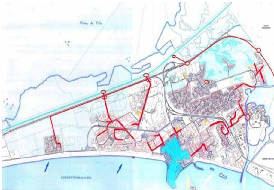
Fig. 11 Plan des diverses insuffisances de collecte des eaux pluviales en rouge. Les linéaires à reprendre concernent 9 sections cadastrales, et les cercles correspondent aux 6 postes de relevage à requalifier.
