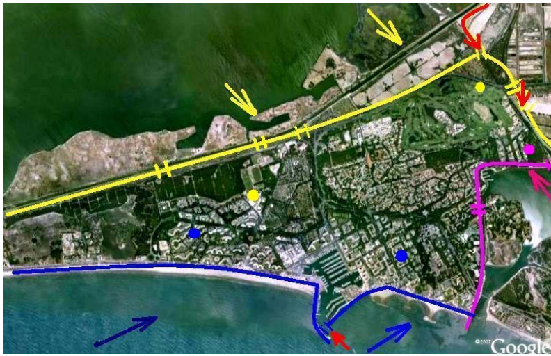
Fig. 8 Surcotes d'origine lagunaire (flèches jaunes), fluviale (f. roses) ou marine (f. bleues), pouvant être imposées à l'espace urbain de La Grande Motte. Les tracés en couleur représentent le continuum polder pour chaque masse d'eau, les doubles traits transversaux les postes de relevage des eaux. Les flèches rouges sont les voies d'entrée à maîtriser de préférence par des automates hydrauliques. Un réseau de piézomètres intégrateurs est à installer pour enregistrer les transferts de charge provenant de chacune des trois masses d'eau : Etang de l'Or, Ponant-Vidourle, Mer (points de couleur).
